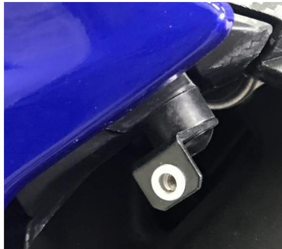
3. Montieren Sie nun die 2 übrigen Gewindeklemmen (6) auf die Halter (3) und (4) und montieren Sie alle Halter am Motorrad (siehe nachfolgende Bilder)
