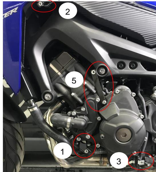
4. Vor dem festen Verschrauben der Halter halten Sie beide Verkleidungsteile an das Motorrad an, richten Sie die Halter aus und ziehen nun alle Schrauben der Halter fest.
