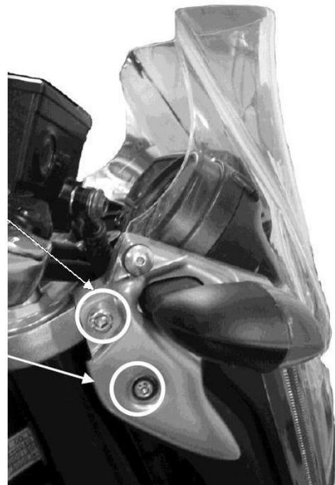
3. Montieren Sie nun die komplette Einheit wie folgt:
