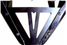
4. Befestigen Sie die untere linke Halterung (5) mit der M5x 20 Schraube (8) wie in Abb.3 & 4 gezeigt am Motor-rad und die linke vordere Halterung (4) mit der Originalschraube wie in Abb.3 gezeigt am Fahrrad. / Loosely fit bottom L/H bracket (5) to bike using M5x 20 flange screw (8) as shown in Fig.3 & 4 and top L/H bracket (4) to bike using original screw as shown in Fig.3
