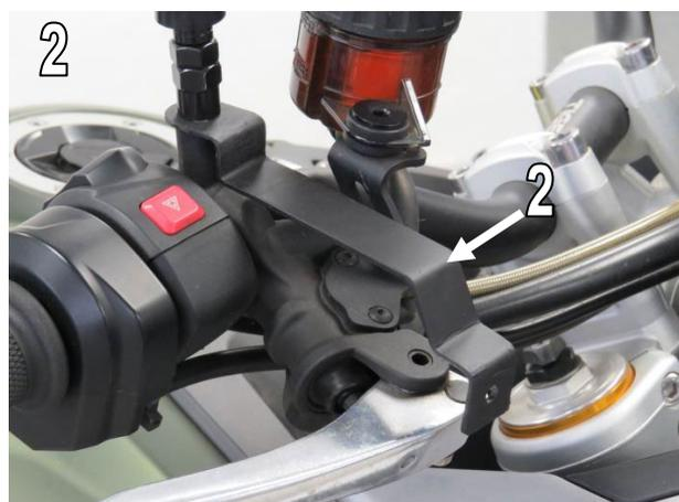
5. Montieren Sie die Lenkerendeneinsätze an den Handprotektoren. Ziehen Sie die Schraube zu diesem Zeitpunkt noch nicht fest Abb.3 / Fit bar end assembly to the hand guards. Do not tighten up the screw at this stage Fig.3
