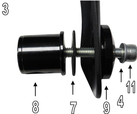
6. Montieren Sie die Handprotektoren mit den Lenkerendeneinsätzen und ziehen Sie die Schrauben(11) fest. Befestigen Sie die Handprotektoren mit den M6 x 20 Schrauben (5) und M6 Muttern (3) an den Halterungen Abb.4 / Fit hand guards using bar end inserts and tighten cap socket screws (11). Fit the hand guards to the brackets using the M6 x 20 screws (5) and M6 Flange nuts (3) Fig.4
