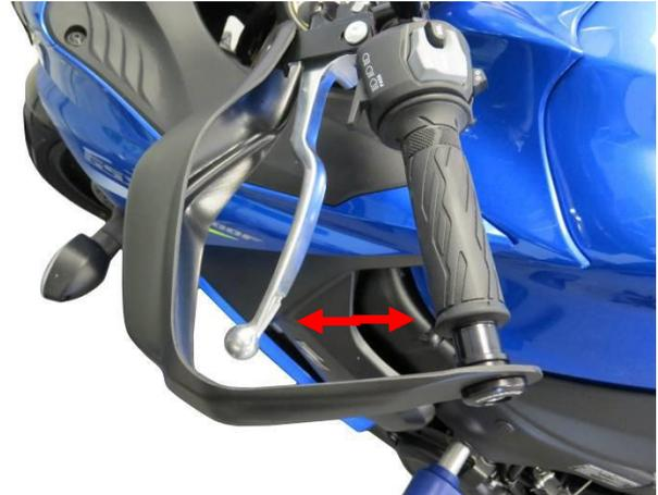
**WICHTIG: Überprüfen Sie regelmäßig die Ausrichtung der Handschützer und die Spannung der Befestigungsschrauben. / IMPORTANT: Always check alignment of hand guards and mounting bolt tension periodically.**
