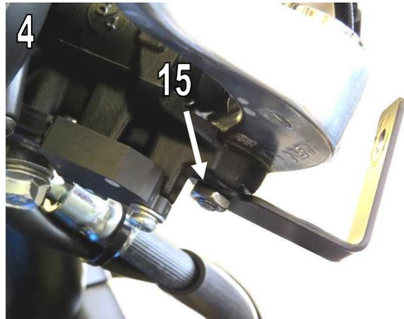
6. Kupplungshebel-Befestigungsschraube entfernen, linke Halterung (2) an der Oberseite des Kupplungskörpers anbringen und eine M6-Unterlegscheibe (9) dazwischen platzieren. Abb.5 / Remove Clutch lever mount screw, locate LH bracket (2) to the top of the clutch body placing an M6 washer (9) between them. Fig.5
