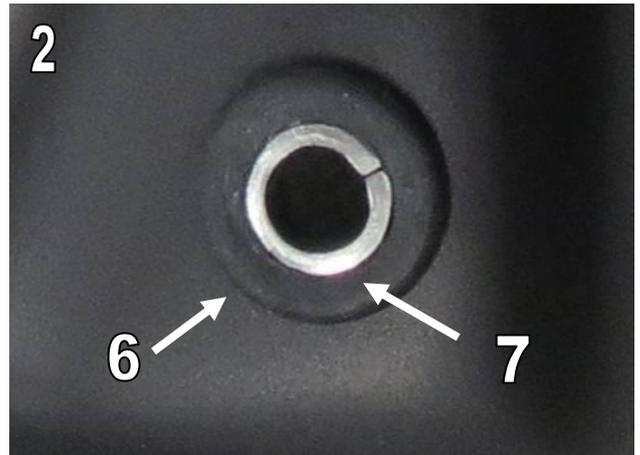
4. Setzen Sie die Gummeinsätze (6) in die Handschützer und die Stahlhülsen (7) in die Einsätze ein. Abb.2 / Fit grommets (6) into the hand guards and spacers (7) into grommets. Fig.2
