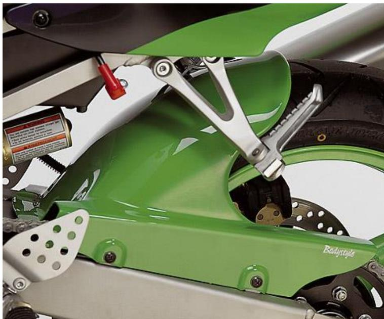
1. Demontieren Sie die originale Hinterradabdeckung und montieren Sie die Bodystyle Hinterradabdeckung an den Originalaufnahmen mittels den original Befestigungsschrauben.
