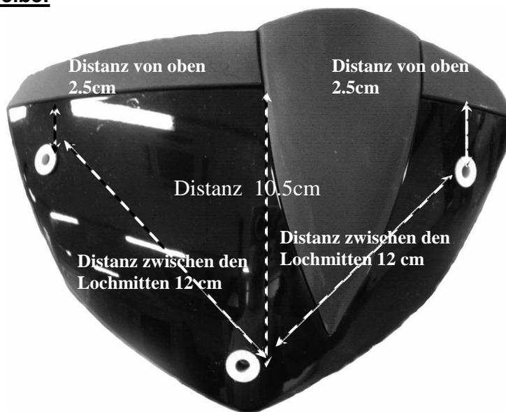
1. Positionieren Sie die Scheibe auf den Armaturen und versichern Sie sich, dass sie mittig sitzt.
