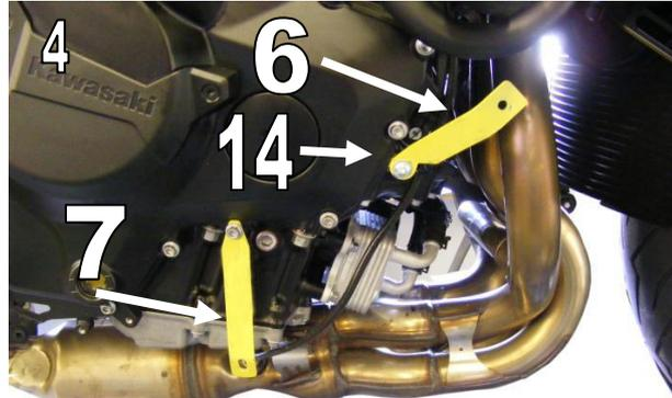
8. Montieren Sie den Bugspoiler an den Haltern mittels der M6x20 Schrauben (11) und der M6 Muttern (10). Sobald der Bugspoiler korrekt ausgerichtet ist, ziehen Sie bitte die Schrauben der Halter fest Abb.7 / *Fit Belly Pan to brackets using M6x20 socket screws (11) and M6 flange nuts (10). Once positioned correctly, fully tighten all brackets. Fig.7*
