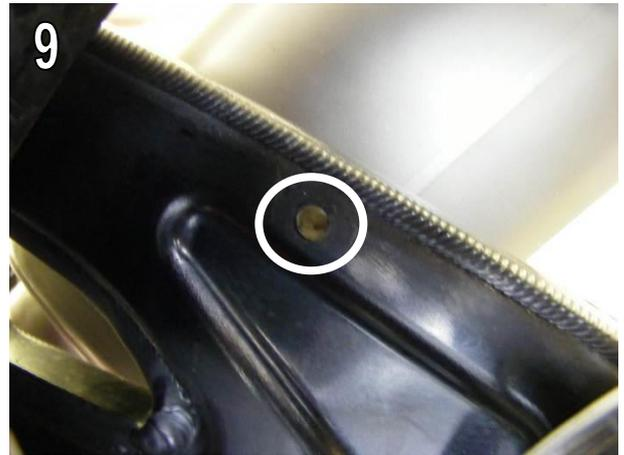
6. Schieben Sie den Gummieinsatz in das Loch der Schwinge Abb. 9+10 und ziehen Sie die Schraube fest sobald der Halter in der richtigen Position ist. / Fit Push well nut into hole on swing arm as shown in Fig. 9+10 and then fully tighten screw once bracket is in correct position.
