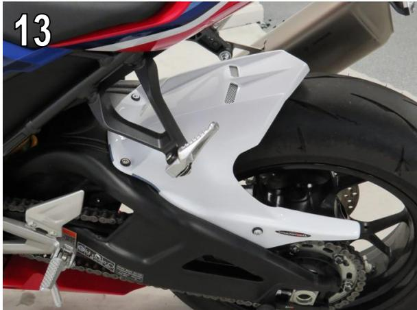
9. Schieben Sie die Kettenschutzseite der Hinterradabdeckung zwischen die Schwinge und den Halter. Abb. 14+15 / *Slide chain guard side of hugger in between bracket and swing arm as shown in Fig. 14+15*
