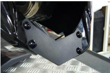
Die Verbindungsplatte muss auf der Aussenseite montiert werden!!!
