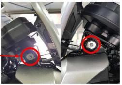
Demontieren Sie nun die 4 Originalschrauben unterhalb der Instrumententafel. Befestigen Sie dann die silberne Scheinwerferverkleidung an dem schwarzen Halter und verschrauben Sie die gesamte Verkleidung von unten am Tacho, wie in folgender Skizze bebildert:
