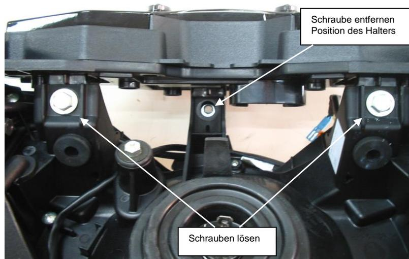
1. Bitte demontieren Sie die Original-Lampenverkleidung und lösen Sie die 2 Schrauben (siehe Bild)
