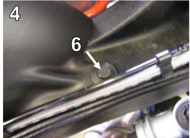
7. Befestigen Sie die Hinterradabdeckung (1) an der linken vorderen Aufnahme mittels der Schraube M5x20 (2) . Abb.5 / Fit Hugger (1) to front L/H hole using screw M5x20 (2). Fig. 5.
