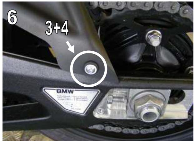
9. Befestigen Sie die Hinterradabdeckung (1) an der rechten hinteren Aufnahme mittels der Schraube M6x25 (4) und Mutter (3). Abb.7 / Fit Hugger (1) to rear L/H hole using screw M6x25 (4) and nut (3). Fig. 7
